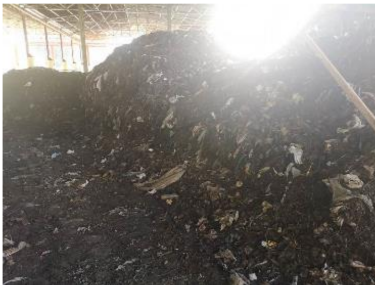
Imagen 5. Pila de compost "vieja", se notan la gran cantidad de bolsas. Fuente: Tratamiento de Desechos Sólidos.
